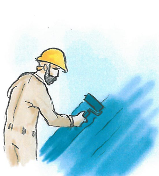
fig. 58: Applicazione del primer a rullo
